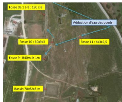
Schéma du système d'injection des eaux des oueds dans la nappe du Charf El Akab
